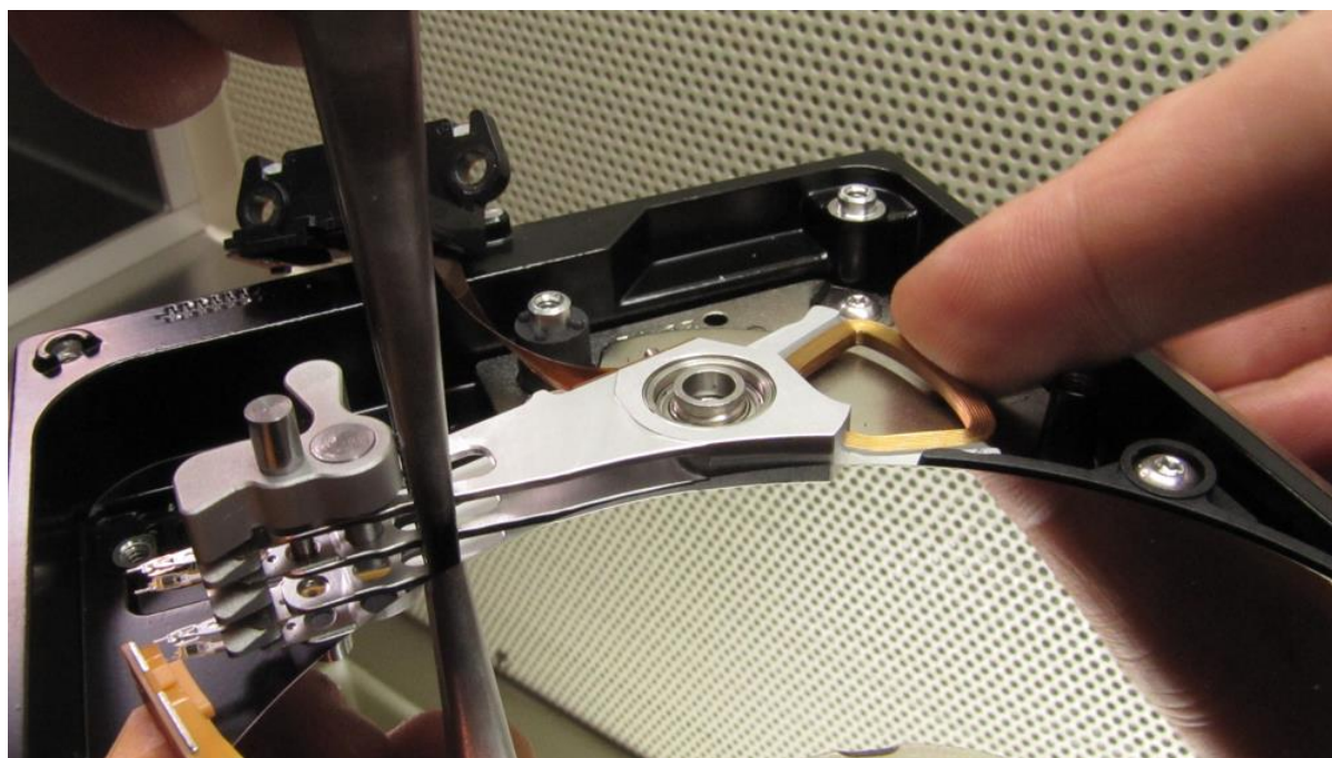
図 6. (故障 HDD にヘッドを取り付ける)
