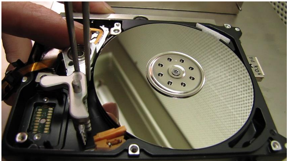
図 13. (故障ドライブにヘッドを取り付ける)
