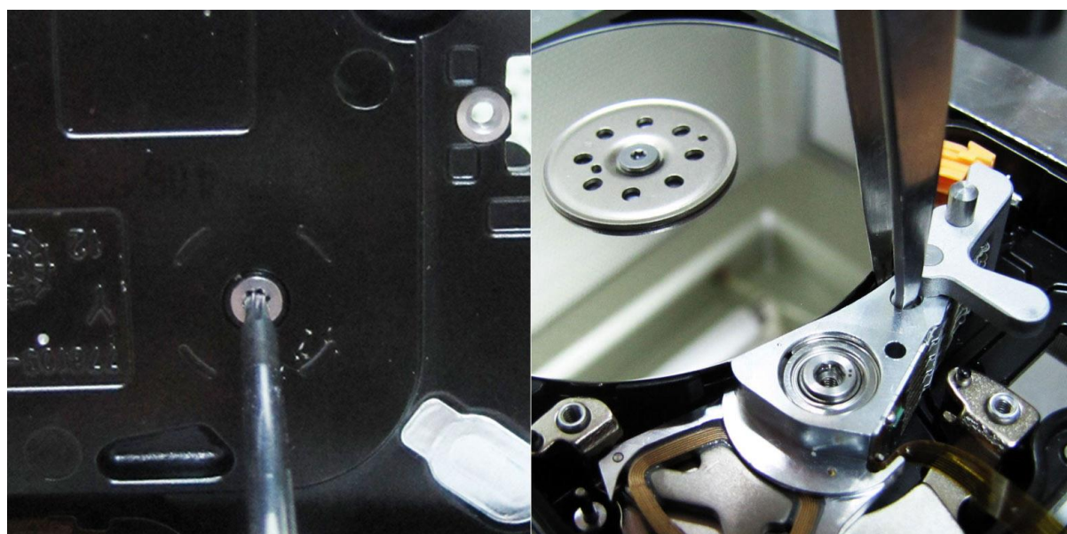
図 16. (4 プラッターの 2.5" ハードドライブのヘッド取り外し)
