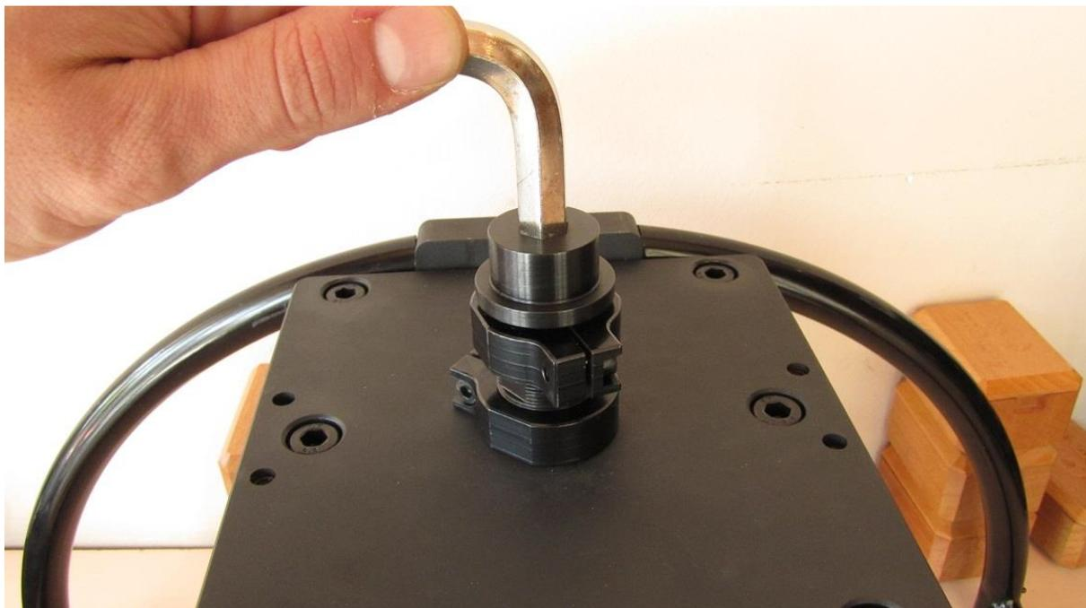
障害 HDD にドナーベアリングを設置します。
