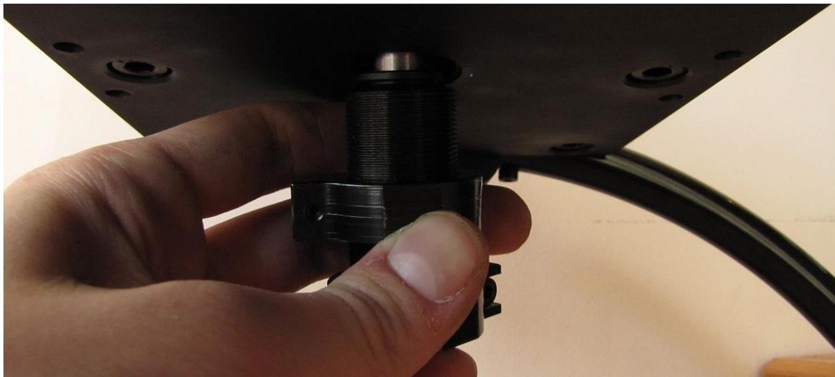
*bottom cylinder+cocoon+bearing* を一緒に回します。
