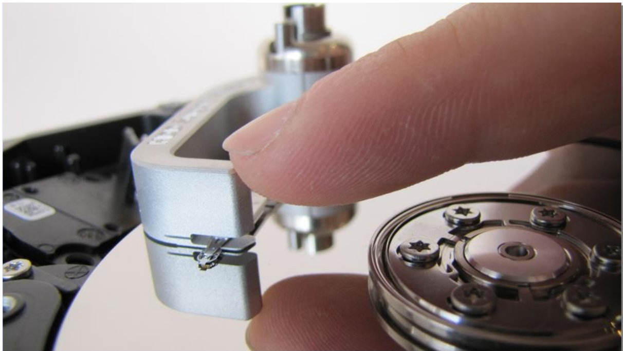
図 5. (プラッターの外側にヘッドを固定したツールを移動させる)
