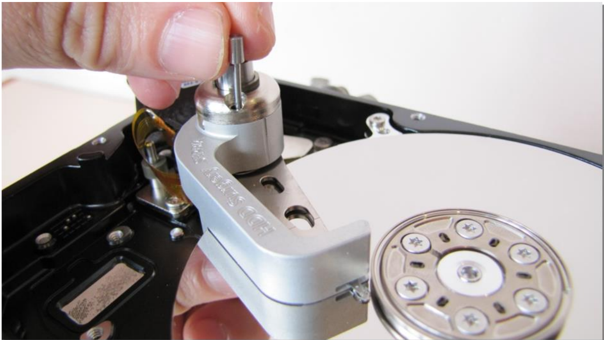
図 8. (固定ピンの取り外し)
