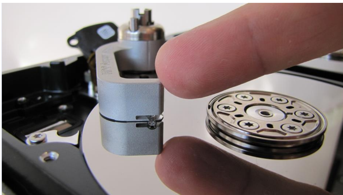
図 5. (ヘッドを固定したツールをプラッターの外に移動させる)
