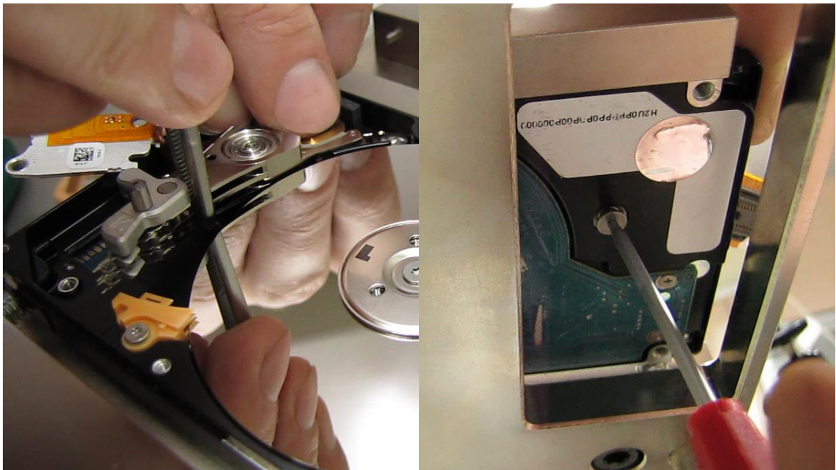
図 6. (故障 HDD にヘッドを取り付ける)
