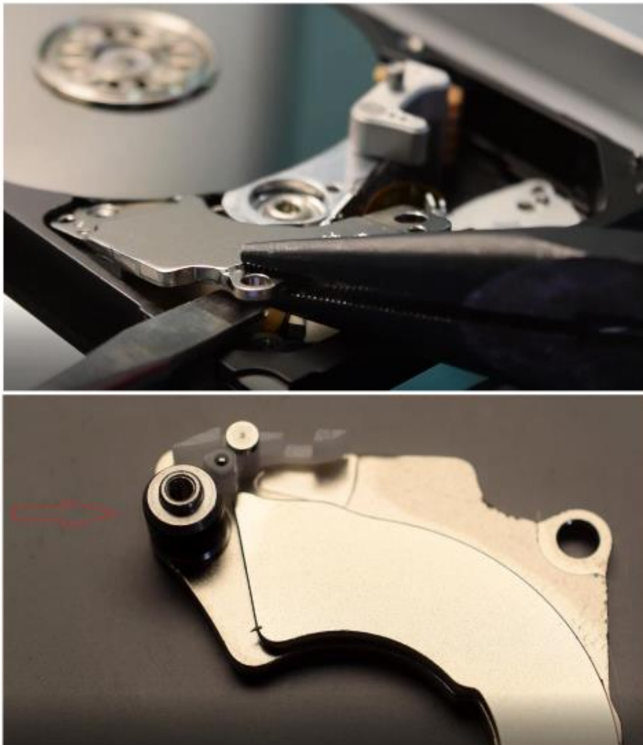
写真 5.7. 上部マグネットの取り外し
