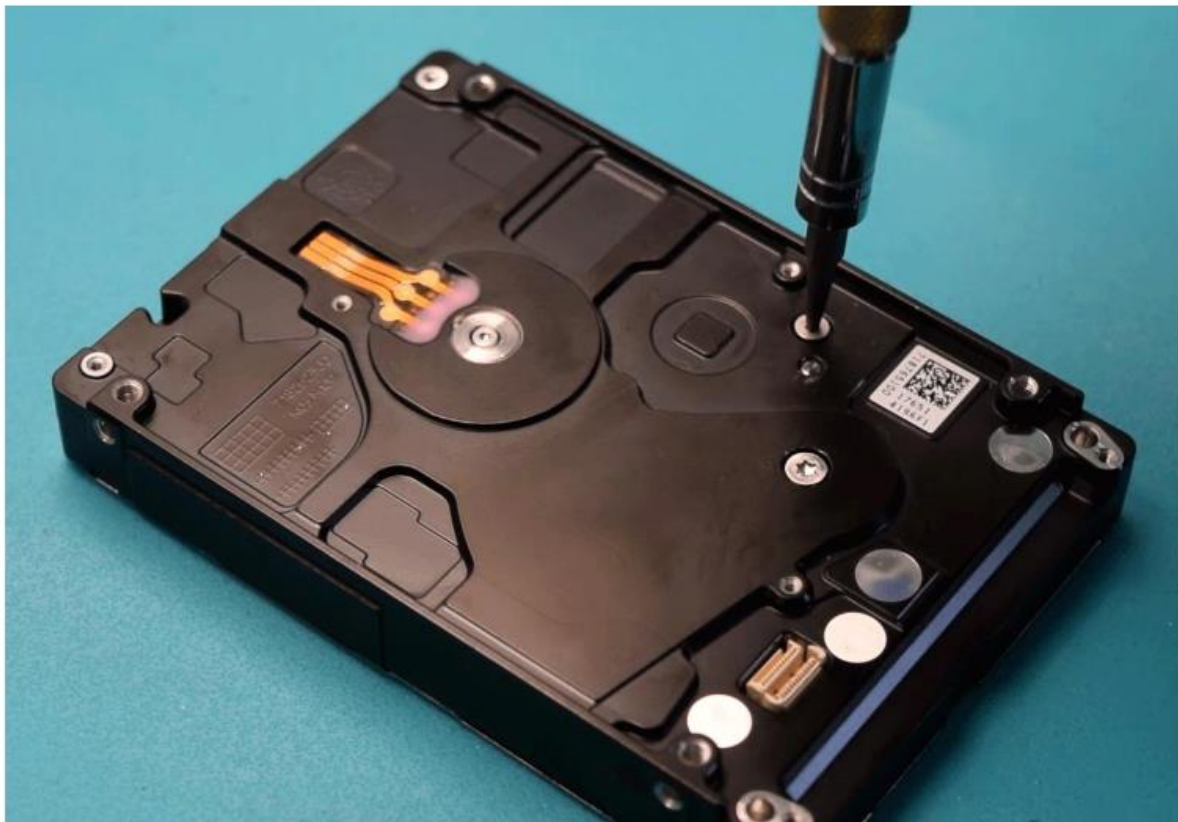
写真 5.2. 底部ネジを外す
