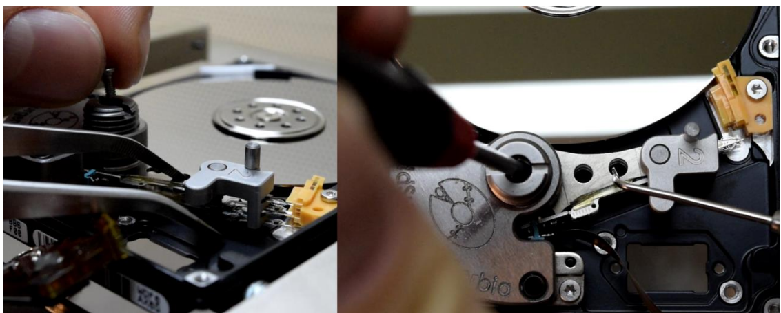
図 6.10 (Cocoon 中のネジを挿入する (左)。サポートツールとヘッドにネジを接続し、固定する (右)。)
