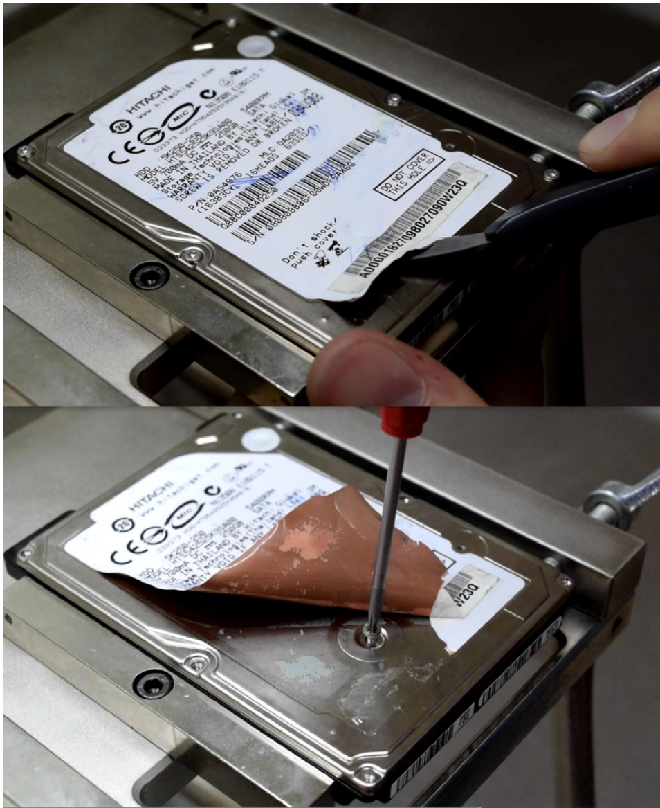
図 6.2 (ハードドライブのラベルの除去 (上) とカバーのネジの取り外し (下) )
