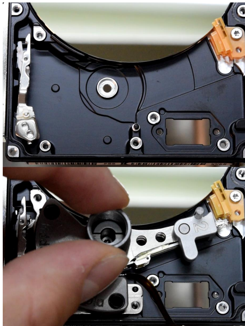
図 6.15 (上 - 損傷ドライブ、下 - 損傷ドライブにヘッドと磁石を設置する)
