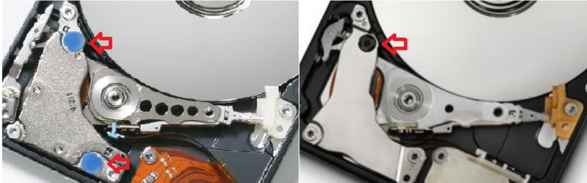
図 4.2 (左 -日立 2.5"ハードドライブで、上部磁石上に2つのセキュリティブレーキを持つタイプ; 右 -上部磁石上に1つのセキュリティブレーキを持つタイプ)
