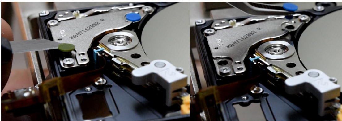
図 6.5 (安全ブレーキの取り外し)
