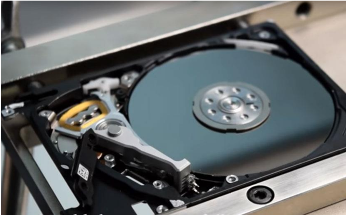
写真 5.10. プラッターからヘッドをスライドさせる
