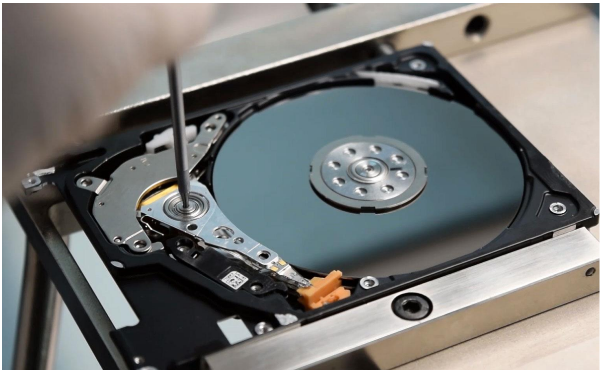
写真 5.1. ボルトを差し込んでヘッドを固定する
