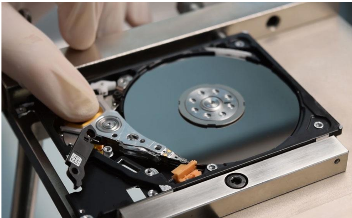
写真 5.4. ヘッドをランプに移動させる
