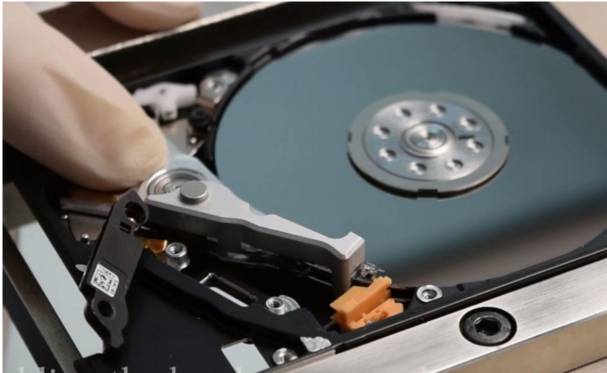
写真 5.7. プラッター上でヘッドを移動させる
