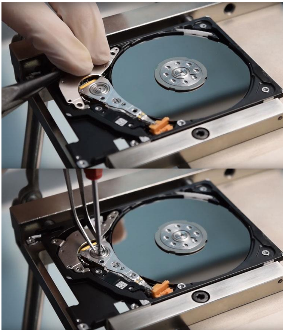
写真 5.19. HAS からネジを外す
