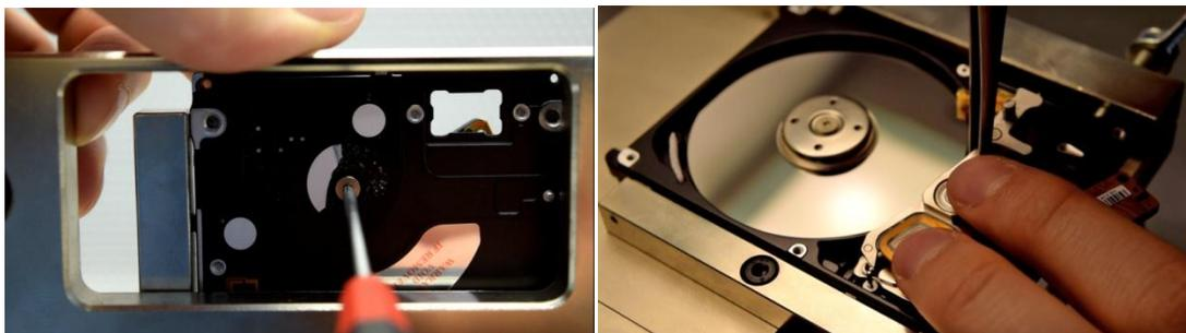
写真 6-11 ヘッドアームアセンブリを固定しているネジを外してヘッドを取り外す
