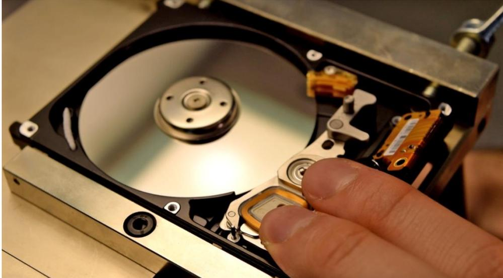
写真 6-10 ドナードライブのランプからヘッドをスライドして移動させる
