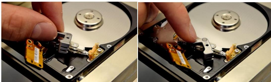
写真 6-5 アームにツールを設置する
