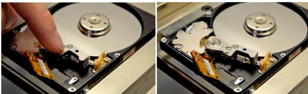
写真 6-6 ツールを回転させると、本体部がヘッドの間に入り込む
