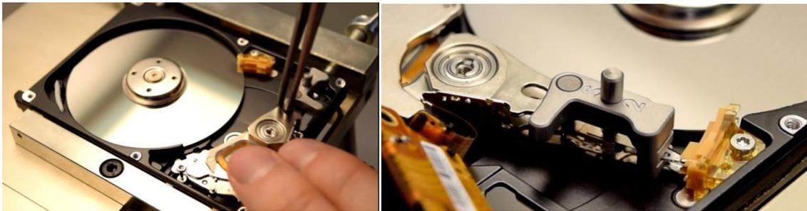
写真 6-12 ヘッドを障害ドライブに設置してランプ上に移動させる
