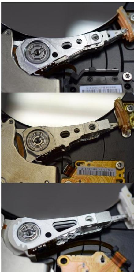
写真 4-1 Samsung 2.5" HDD アクチュエーターアームの 2 つの異なる穴
