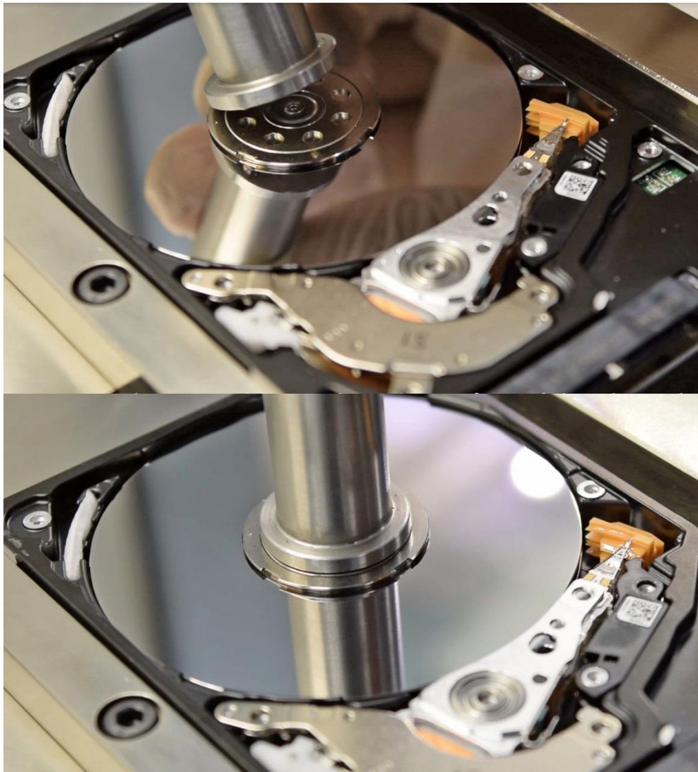
写真 3.2. プラッターホルダー表面にツールを合わせる
