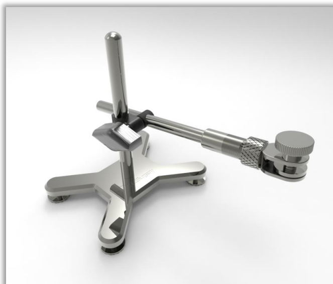
写真 3.7. 組み立てが完了したヘッドホルダーツール
