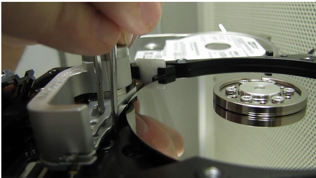
図 7. (故障 HDD にヘッドを取り付ける)
