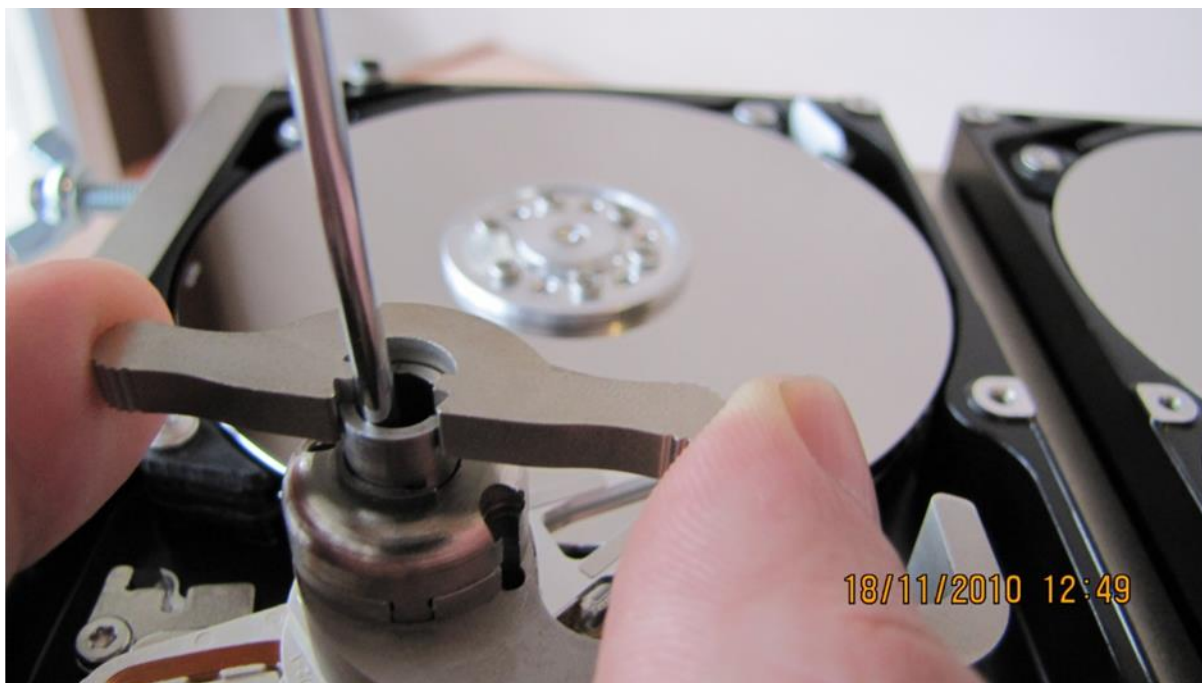
図 10. (補助ツールを使用してツールを取り外す)
