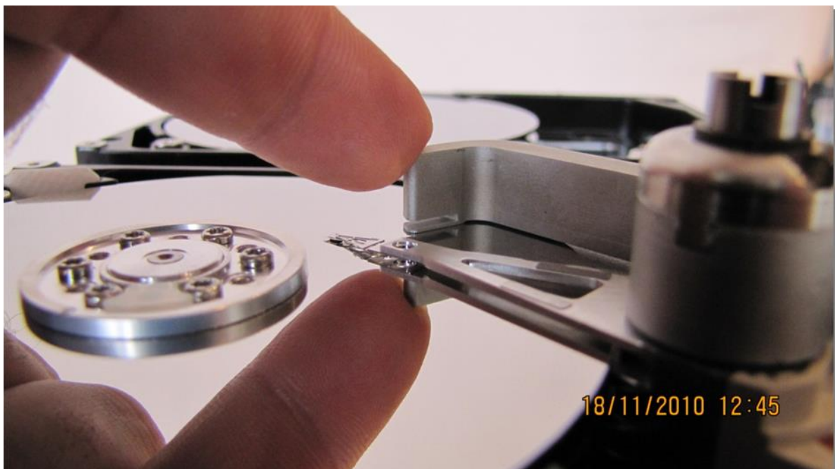
図 9. (ツールをプラッターの外に移動させる)
