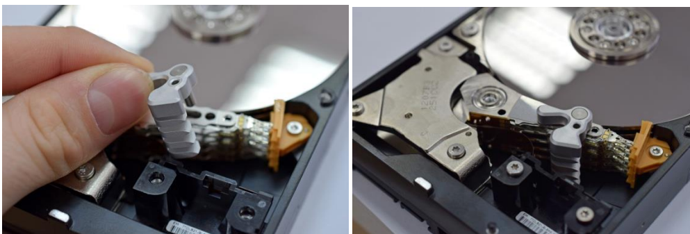
写真 6-2 ツールをアクチュエーターアームに設置する
