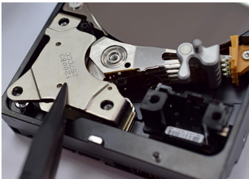
写真 6-10 マグネットを元に位置に取り付ける
