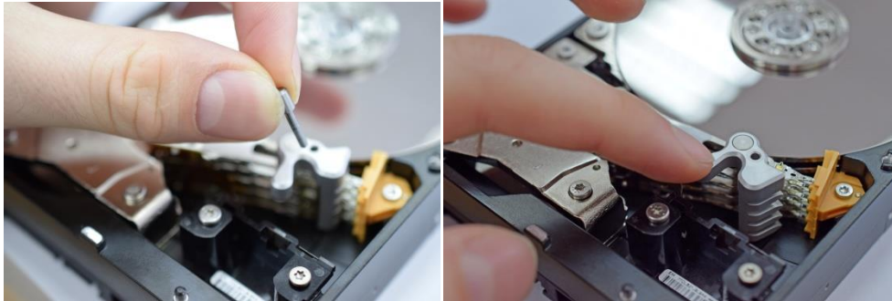
写真 6-11 ピンを抜いてツールを取り外す
