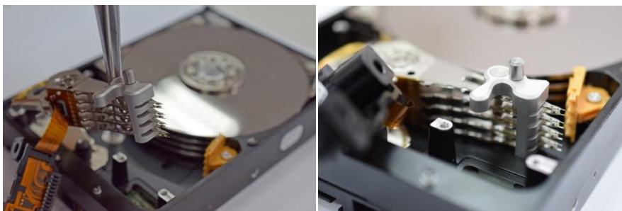
写真 6-9 ヘッドを障害ドライブに設置してランプ上に移動させる
