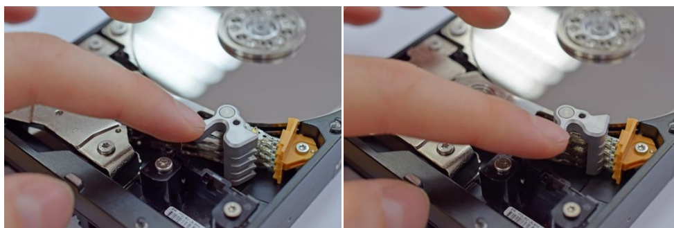
写真 6-3 ツールを回転させ、本体部をヘッドの間に入れ込む
