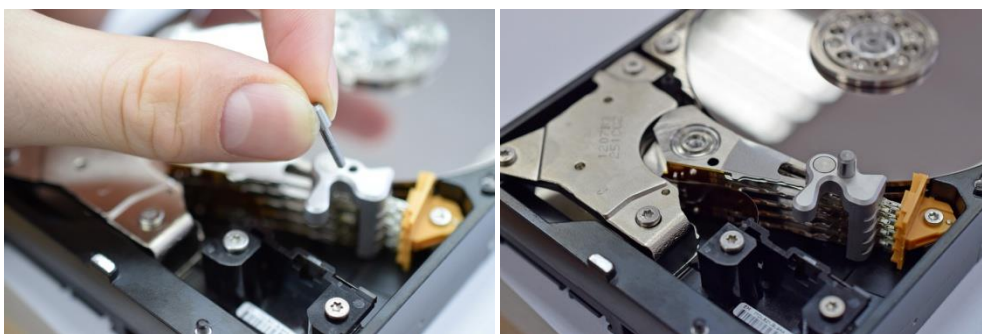
写真 6-4 ツールでヘッドを固定する
